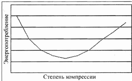
Рис. 3. Зависимость общего энергопотребления (передатчик + процессор) от степени компрессии данных
