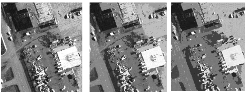
Рис. 3.11. Многоуровневая сегментация полутонового изображения.
